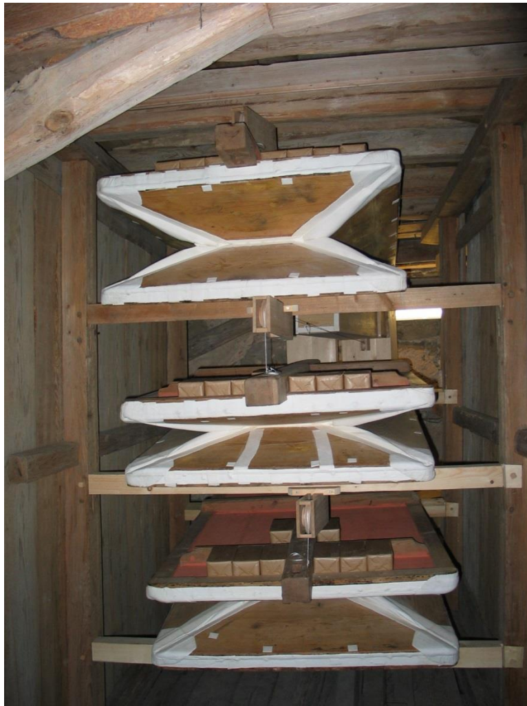
Die drei Keilbälge liegen wieder an ihren angestammten Plätzen im originalen Lagerwerk
